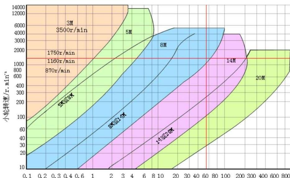
图 3-10 麦迪三维设计工具弧齿同步带选型图
