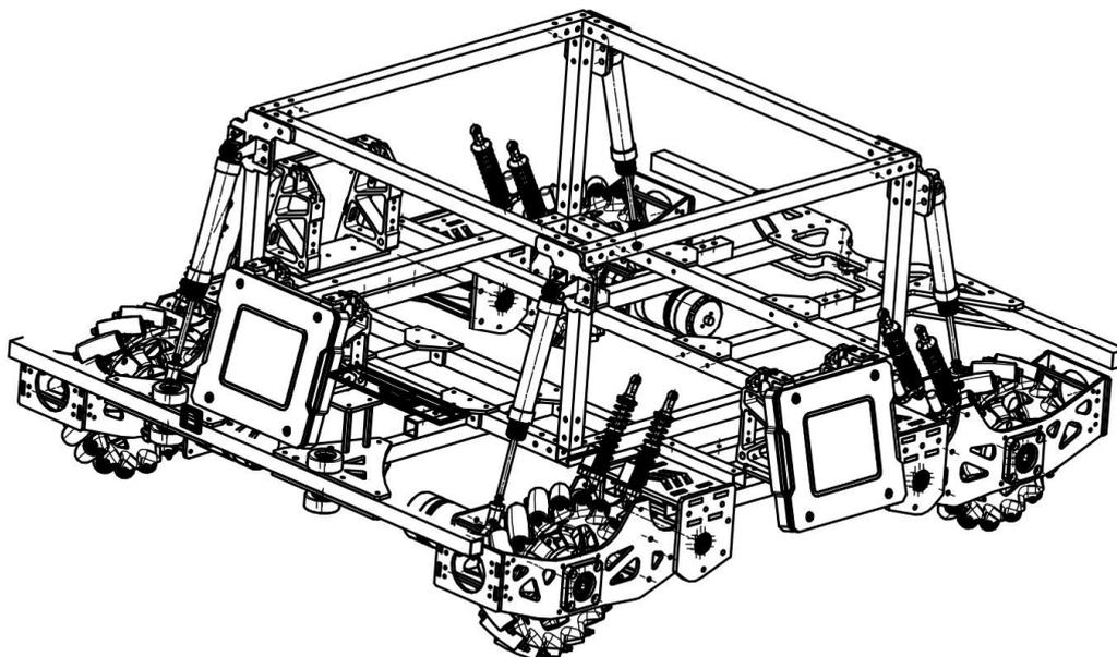
图 3-8 工程机器人行驶系统结构图
