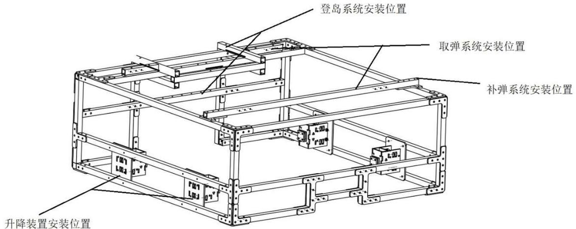
图 3-14 固定框结构图
