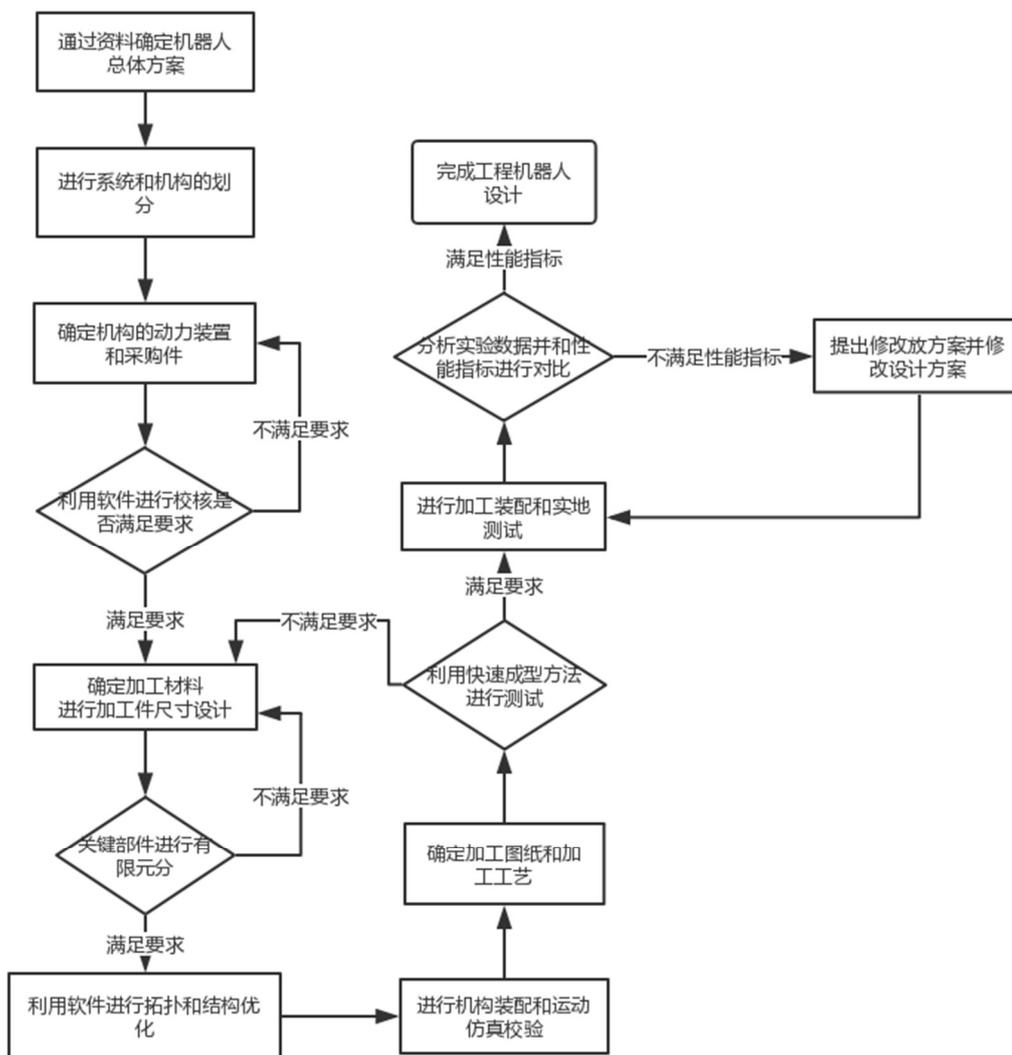
图 1-7 工程机器人设计的技术路线
