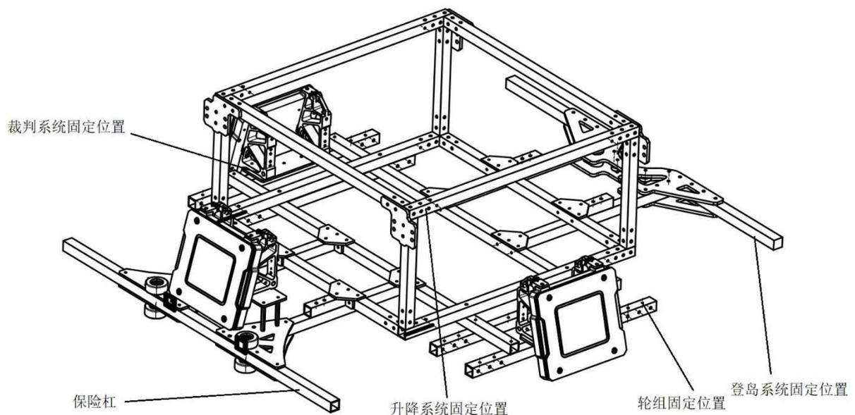
图 3-8 底盘车架结构图
