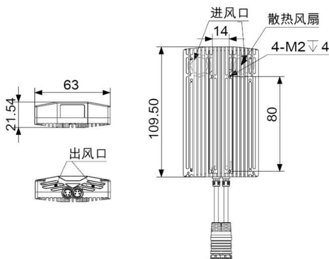
图 2-2 Robomaster2019 赛季官方提供的图传发射端
