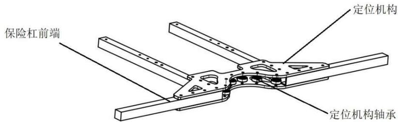
图 3-16 定位机构和保险杠的装配结构
