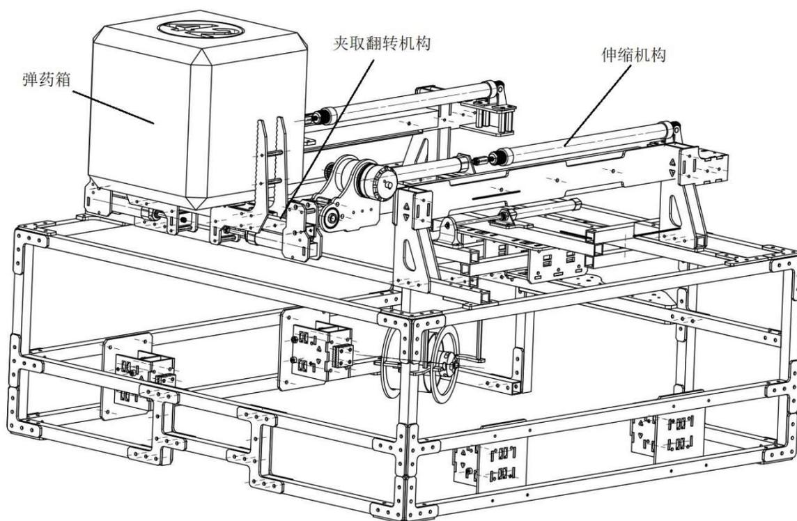
图 3-24 取弹机构装配结果
