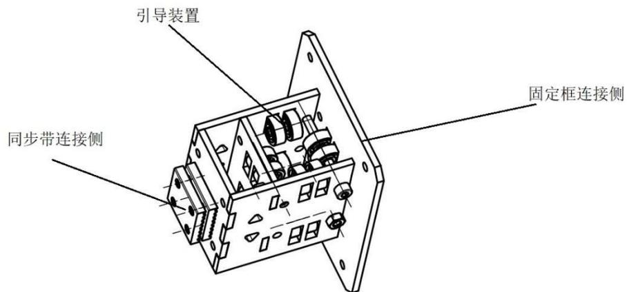
图 3-12 轴承引导滑轨结构图
