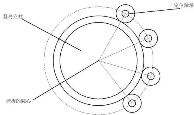
图 3-15 定位机构原理图
