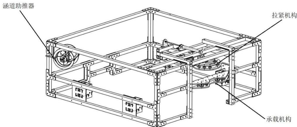
图 3-21 登岛系统在固定框的安装位置
