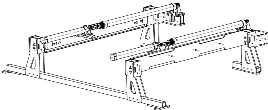
图 3-23 取弹系统伸缩机构
