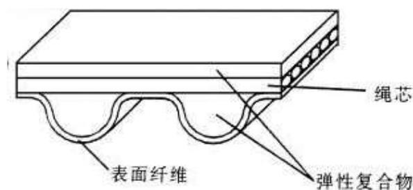
图 2-6 弧齿同步带结构
