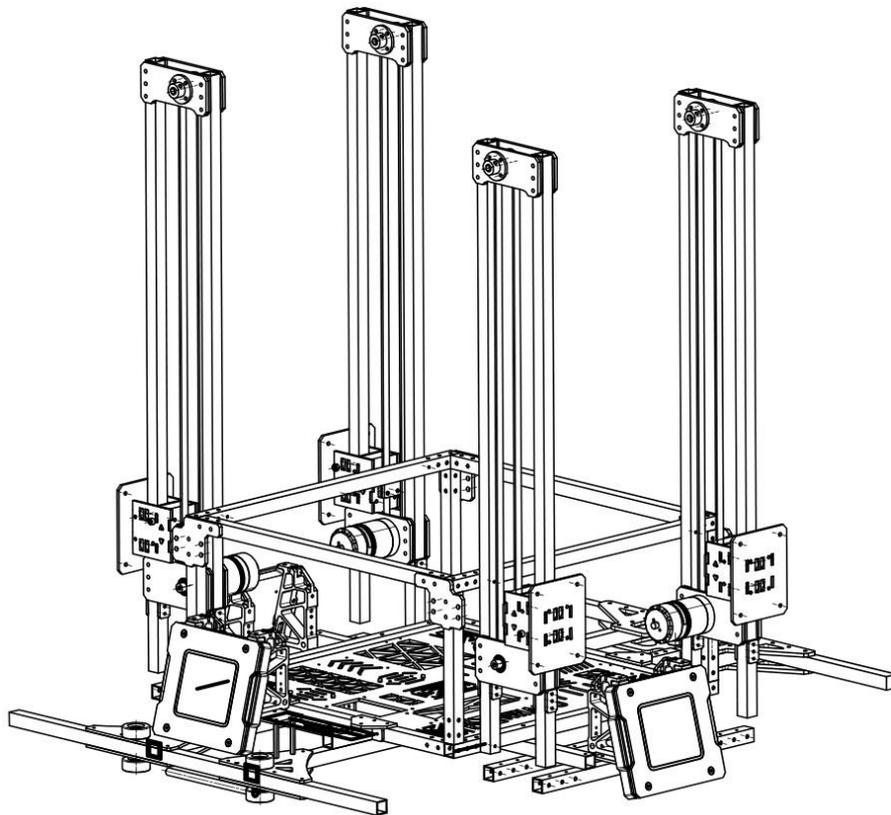
图 3-13 升降机构和底盘车架连接方式
