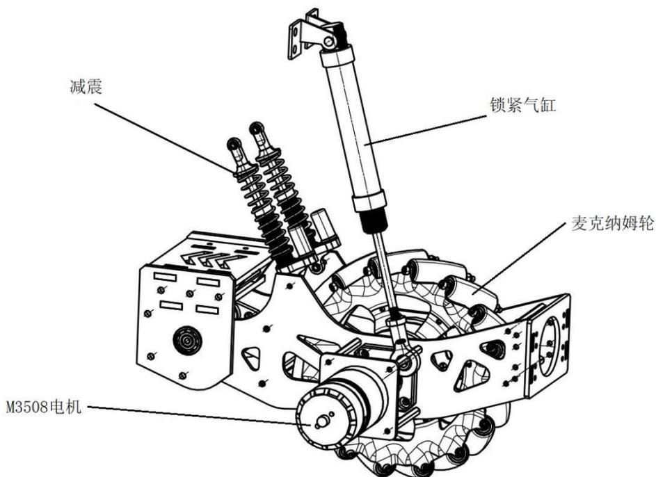
图 3-3 底盘轮组结构图
