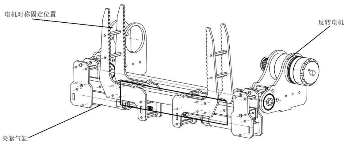
图 3-22 夹取反转机构
