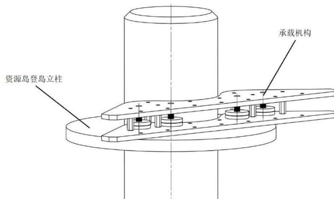
图 3-19 承载机构和资源岛立柱配合方式
