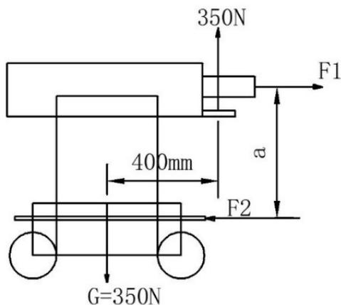
图 2-7 工程机器人抱柱过程中受力分析
