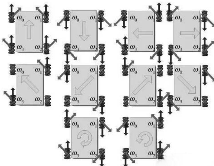
图 2-5 米字型布置麦克纳姆轮平台运动简图
