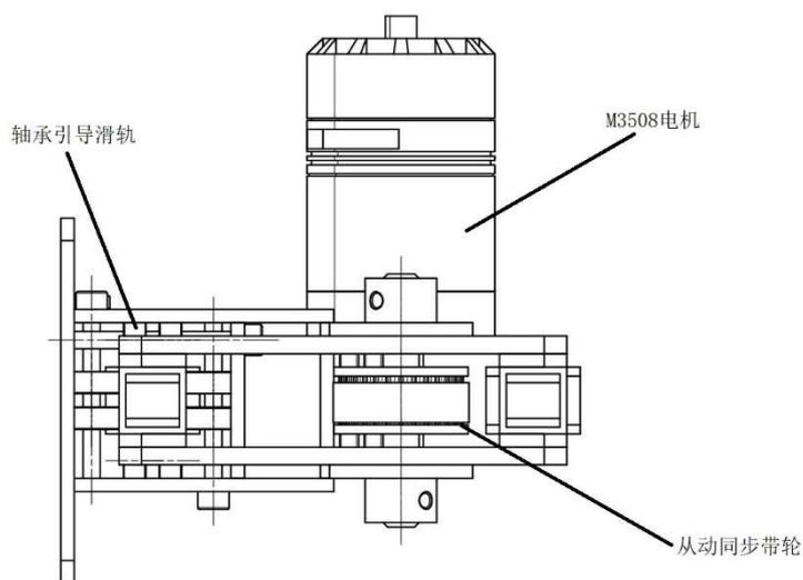
图 3-11 升降装置结构图
