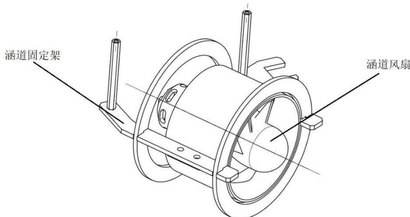
图 3-20 涵道助推器的结构图
