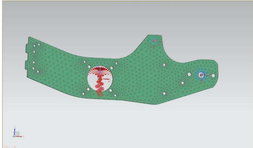
图 3-5 麦克纳姆固定边板分析模型
