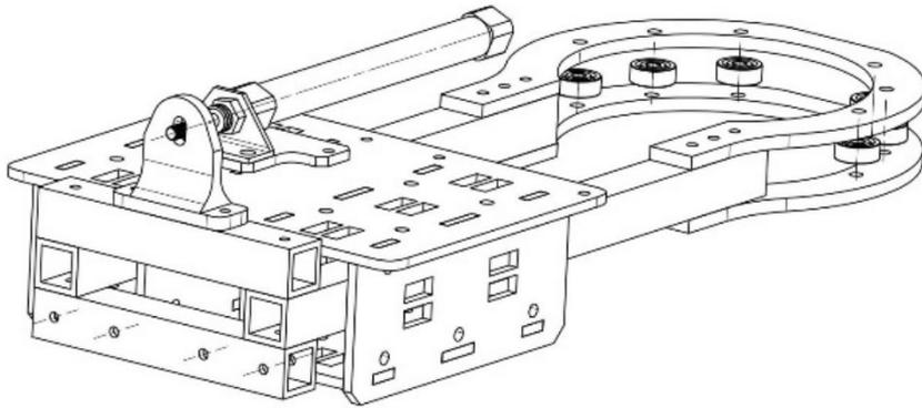
图 3-18 拉紧机构伸出状态
