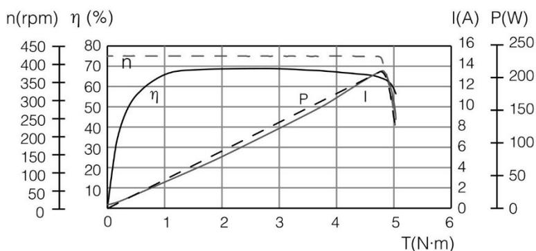
图 3-2 M3508 电机使用 C620 电调做速度闭环控制负载特性曲线
